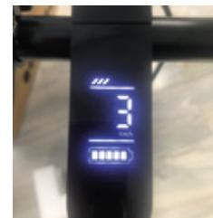
MODO 3: Limita la velocidad máxima a 25 Km/h. (máxima velocidad del patinete).
